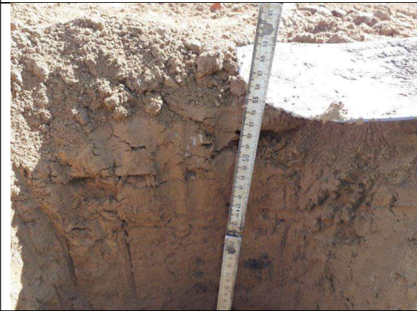
Photographie 40: confinement avec minimum 50 cm de terres saines
